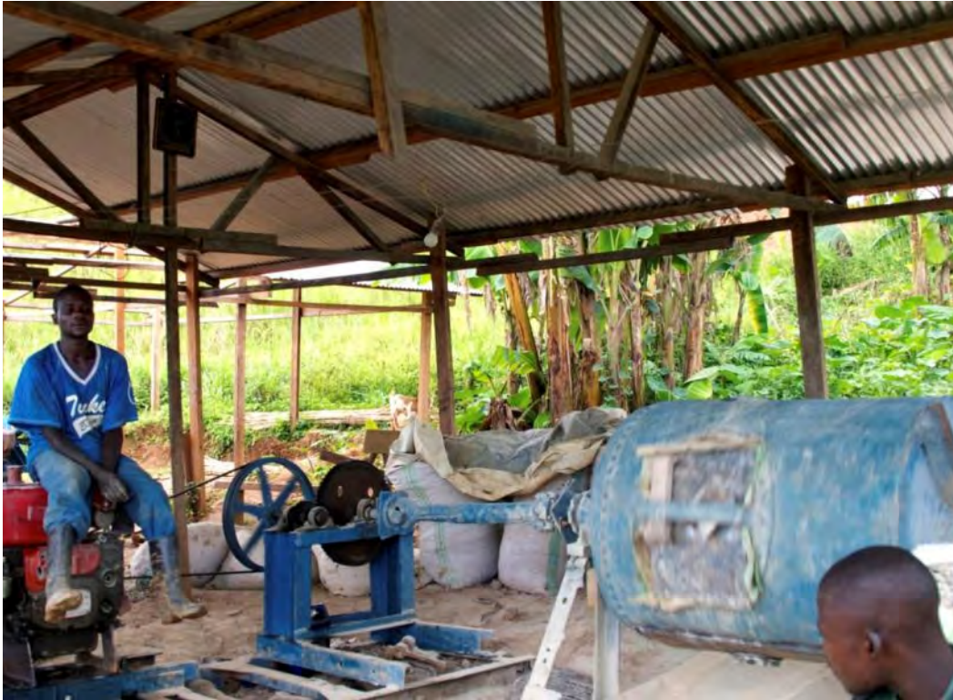
Photo 7 : concassage mécanisé des grands cailloux a Mongbwalu (Djugu)
