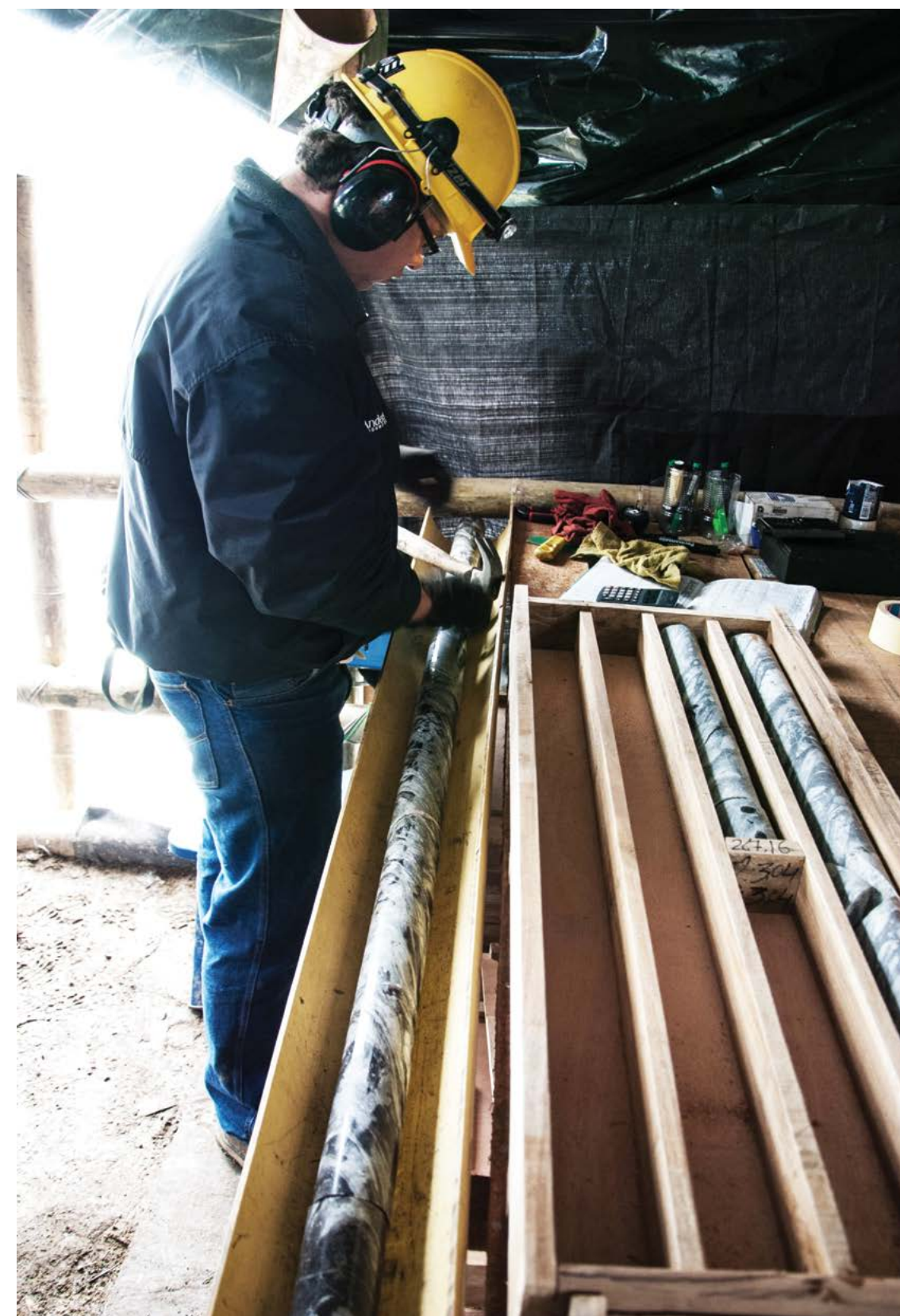
En una palataforma de perforación, un ingeniero de AGAC analiza un muestreo de suelo para determinar la cantidad de metales presentes en el (2011).
