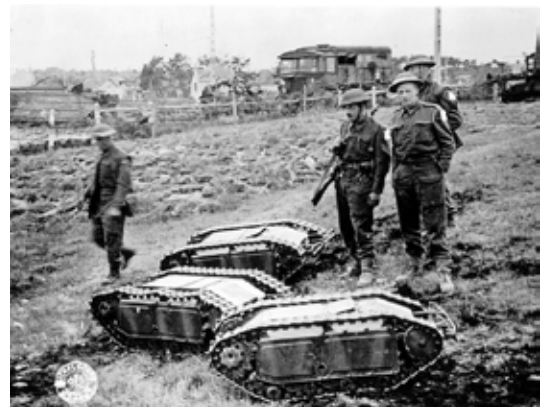
Duitse radiografisch bestuurbare mini-tanks met explosieven in wo II.
